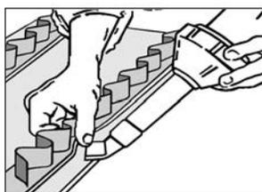
Borde lateral de contención con base para ser soldado por aire caliente de forma manual con el soldador Leister.
